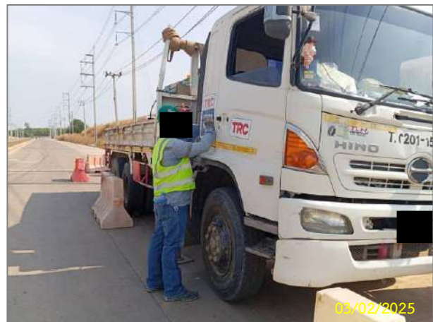
การตรวจสอบสภาพของอุปกรณ์ยกก่อนใช้งาน
